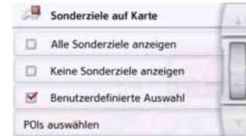
Durch die Auswahl von **Alle Sonderziele anzeigen** werden in der Karte alle Sonderziele angezeigt.
