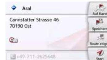
> Drücken Sie in den Sonderziel Informationen auf die im unteren Teil angezeigte Taste mit dem Symbol . Der Rufaufbau wird gestartet.
