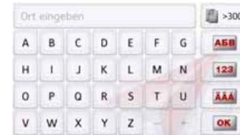
In der oberen Schreibzeile zeigt das Eingabemenü die über die Tastatur eingegebenen Zeichen an. Der mittlere Bereich dient der Zeicheneingabe. In der rechten Zeile werden Hilfsfunktionen zur Verfügung gestellt. Nachfolgend wird deren Bedienung beschrieben.
