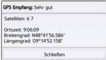
Sie können ersehen, wie viele Satelliten empfangen werden, und ob der Satellitenempfang ausreichend für die Navigation ist. Zusätzlich werden die aktuelle Uhrzeit und die Geoposition angezeigt.
