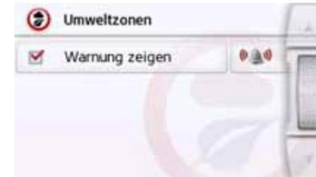
Sie können sich, sofern diese Informationen im Kartenmaterial gespeichert sind, und von Ihrem Navigationsgerät unterstützt werden, vor Umweltzonen warnen lassen. Die Funktion kann eingeschaltet  oder ausschalten  werden. Durch Drücken auf das Symbol mit der Glocke kann der Warnton eingestellt werden (🔔) Warnton eingeschaltet). > Bestätigen Sie Ihre Einstellungen durch Drücken der Taste .
