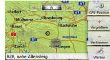
Außer dem pulsierenden Punkt erscheinen am oberen Rand ein Kompass und zwei nach links bzw. rechts weisende Pfeiltasten.
